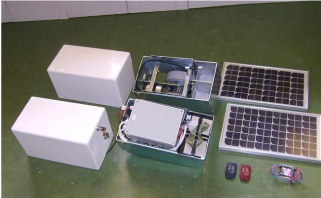
Chaque kit de motorisation se compose de deux modules tracteurs jumelés fixés de chaque côté de l'abri, soit une traction par deux moteurs et deux roues.
